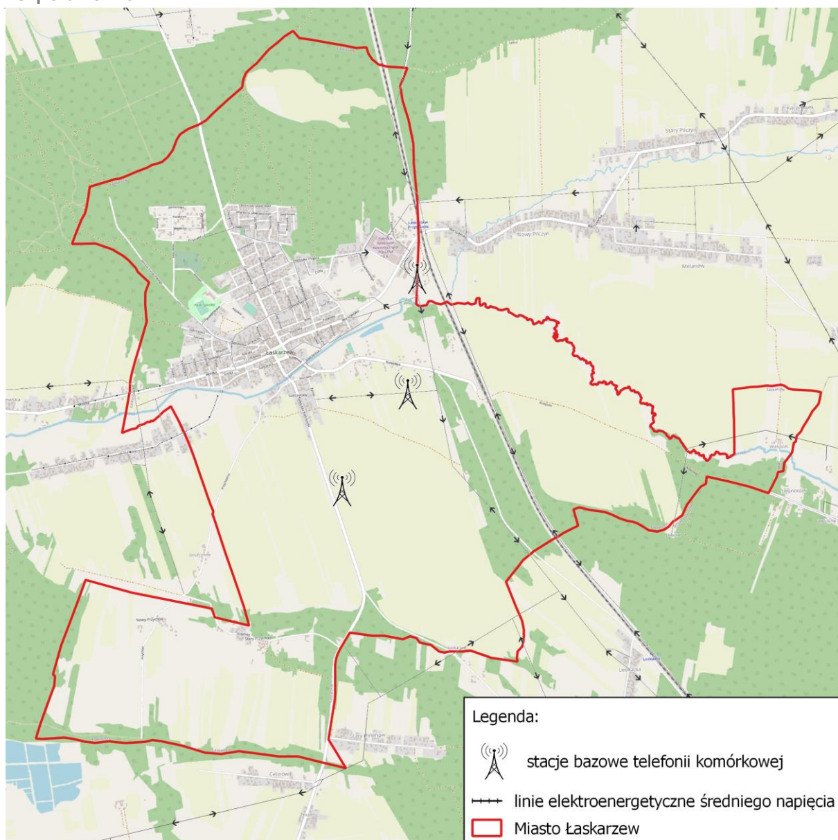
Rysunek 4. Lokalizacja stacji bazowych telefonii komórkowej oraz linii średniego napięcia na tle Łaskarzewa Źródło: opracowanie własne na podstawie btsearch.pl oraz mapy sieci elektroenergetycznej www.ebin.josm.pl/electricity
